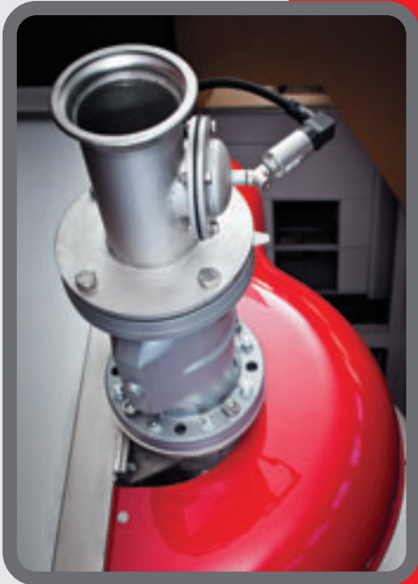
VALVOLA ASSIALE PNEUMATICA COMPLETA DI TRASDUTTORE DI PRESSIONE RENDENDO POSSIBILE LA MODIFICA A QUADRO DEI VALORI SENSIBILI DI PRESSIONE.
